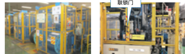
一项为降低制造工序中卷入复绕机活动部位的风险而采取的举措 焊接事业部门茨木工厂案例 (推进在活动部位安装具备联锁功能的防护栏等)
