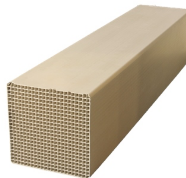
ハニカム型脱硝触媒 150mm □ ×700mm L , V,W/TiO 2
