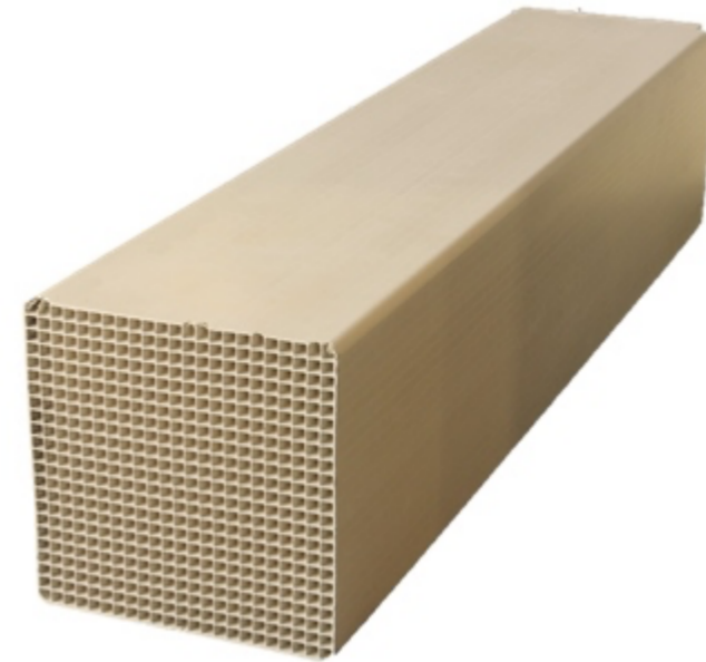
八ニカム型脱硝触媒 150mm□×700mm L , V,W/TiO 2
